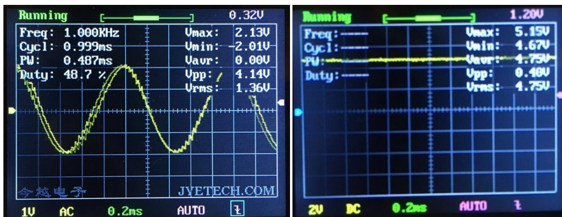
Рисунок 5 – Осциллограммы частоты и выходного сигнала при резонансе
