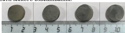
Рисунок 2 – Образцы керамики, полученные методом SPS
