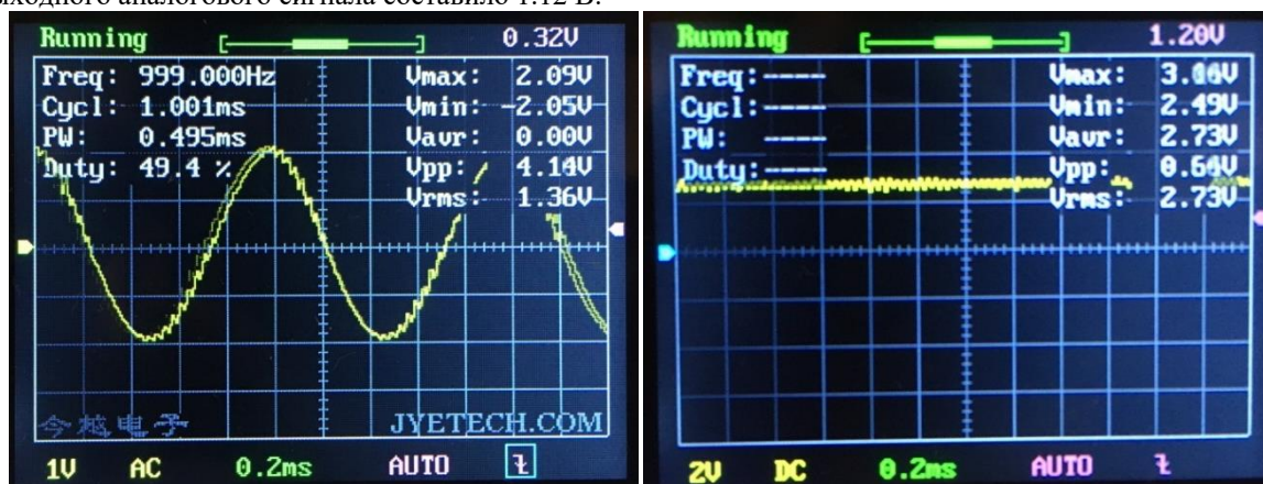
Рисунок 4 – Осциллограммы частоты и выходного сигнала
