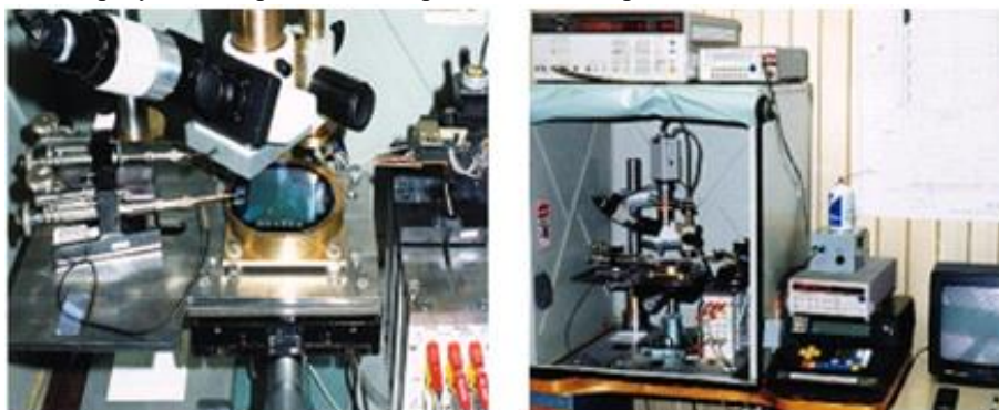
Рисунок 4 – Стенд на базе многозондовой установки для проведения радиационно-термического тестирования тестовых структур КМОП БИС
